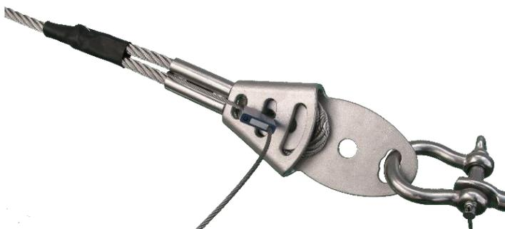
Système de terminaison manuelle plombée. Ce système permet la pose de la ligne de vie sans serre-câble et sans presse hydraulique. Ce système breveté est sûr et a une résistance supérieure à 3800daN. Une fois plombé, le système est indémontable.
