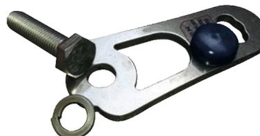
Pièce en acier inox 304 passivée et polie permettant la liaison entre les extrémités de la ligne de vie et les potelets d'extrémité. Elles peuvent être superposées dans le cas d'une double extrémité. La ligne de vie doit obligatoirement être dans le plan de l'adaptateur.
