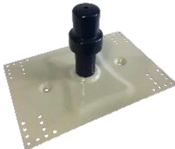
Gamme de potelets déformables sur structure légère. Ils permettent de se reprendre directement sur le bac acier ou d'autres types de structures par l'intermédiaire de vis à bascule, de rivets, ou de vis autoforeuses. Résistant à 1900daN, ils sont compatibles avec la ligne de vie SecurLine seulement sous certaines conditions (voir la notice de montage).
