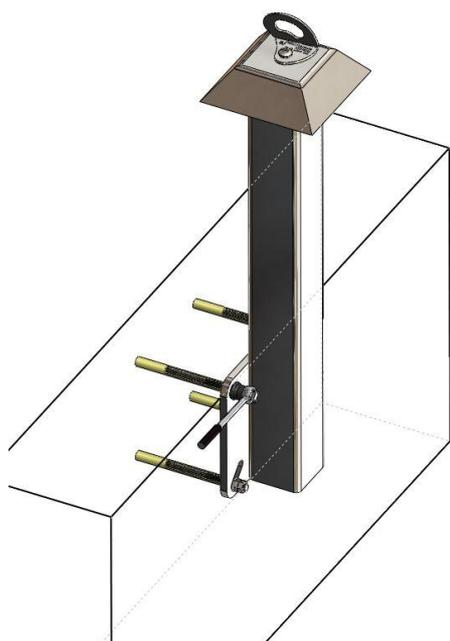
Une reconstitution du plan d'étanchéité à l'eau au passage du potelet doit être effectuée selon les règles de l'art (DTU série 40-3 et DTU série 43).
