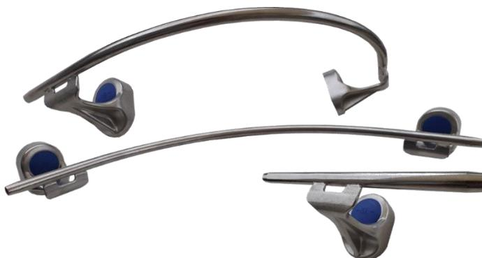
Passants OH en inox 304 passivés et électropolis, ces passants sont utilisables avec la navette SL50. Il existe 3 types de passants Over Head : le SL30-OH (intermédiaire sans angle), le SL31-OH-E pour les angles à 90° extérieur et les passants SL31-OH-I pour les angles à 90° intérieur.
