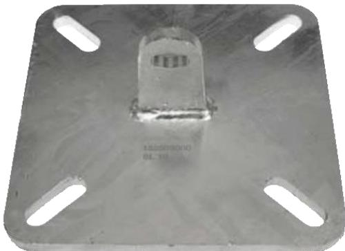
Platine d'extrémité en acier galvanisé. Peut être mise en position plafond. Elle se fixe sur une structure métallique ou sur une maçonnerie. Cette platine permet de mieux répartir la charge par rapport à la platine SL11. On la privilégiera pour des maçonneries anciennes.
