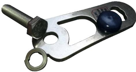
Pièce en acier inox 304 passivée et polie permettant la liaison entre les extrémités de la ligne de vie et les interfaces d'extrémité. Elles peuvent être superposées dans le cas d'une double extrémité. La ligne de vie doit obligatoirement être dans le plan de l'adaptateur.
