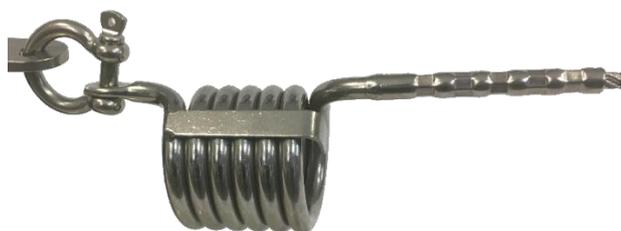
Absorbeur en inox 316 avec une manille lyre inox, une goupille fendue et un manchon à sertir diamètre 13mm. Présente les mêmes caractéristiques mécaniques que SL07.
