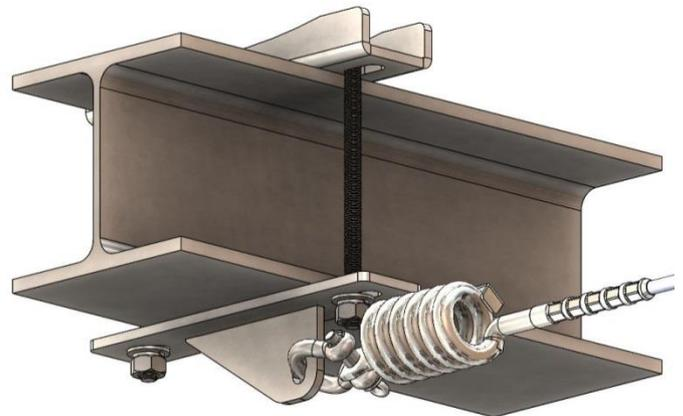
Les platines de départ SL11 doivent être mises en place par l'intermédiaire de 2 fixations M12 en inox. Si les fixations sont reprises dans un mur en béton, nous conseillons d'utiliser des scellements chimiques. Le couple de serrage des fixations devra être de 35Nm.
