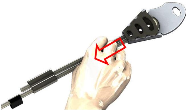
Rapprocher le double tube de la boîte à coin pour bloquer le câble. Mettre en place le plomb. Couper le câble et chauffer le thermodurcissable pour améliorer la finition :
