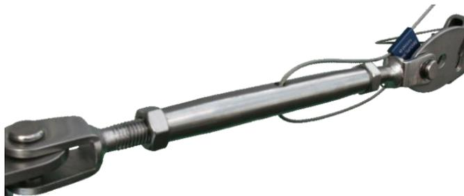
Tendeur chape-chape en inox 316. Permet de reprendre la tension du câble grâce à sa course de 23cm. **Un plomb avec un numéro de série** est fourni. SecurLine **recommande une tension de 80daN**.
