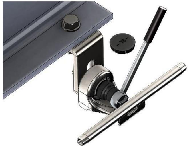
Les passants SL30-OH se mettent en place sur leur support par l'intermédiaire d'une vis M12 inox tête hexagonale. Le cache PVC doit être mis en place après le serrage au couple de 35Nm.
