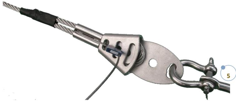
Système de terminaison manuelle plombée. Ce système permet la pose de la ligne de vie sans serre-câble et sans presse hydraulique. Ce système breveté est sûr et a une résistance supérieure à 3800daN. Une fois plombé, le système est indémontable.
