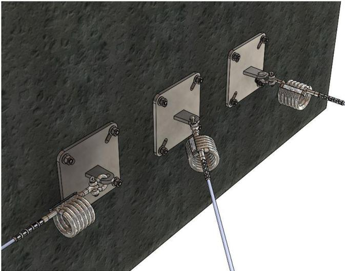
Les platines de départ SL16 doivent être mises en place par l'intermédiaire de 4 fixations M12 en inox. Si les fixations sont reprises dans un mur en béton, nous conseillons d'utiliser des scellements chimiques. Le couple de serrage des fixations devra être de 35Nm.
