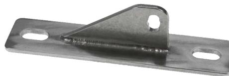
Platine d'extrémité en inox 304. À mettre en position plafond. Elle se fixe sur une structure métallique ou sur une maçonnerie suffisamment dimensionnée par l'intermédiaire de deux fixations M12 (voir la notice de montage).
