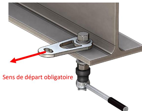
Les adaptateurs d'extrémité SL14 peuvent être montés directement sur la structure d'accueil ou sur des interfaces sur mesure par l'intermédiaire d'une vis M12 inox. L'anti-desserrement est réalisé par une rondelle grower qui est placée entre la SL14 et la tête de la vis.
