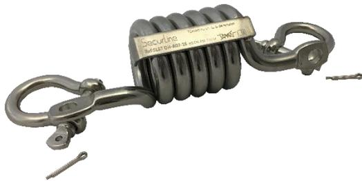
Absorbeur en inox 316 à dissipation d'énergie par déformation plastique avec 2 manilles lyres inox et goupilles fendues. **Le plateau de déformation plastique se situant entre 900daN et 1100daN**, les efforts en extrémité se limitent donc le plus souvent à cette zone de valeur. La course de l'absorbeur est de 0.65 mètre, ce qui lui permet d'absorber beaucoup d'énergie.
