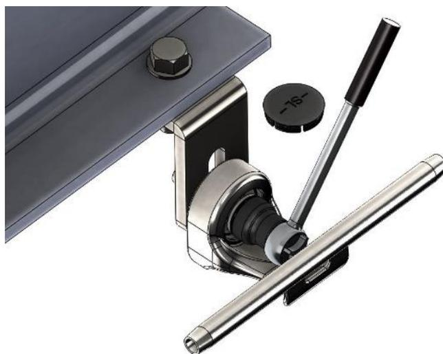
Les passants SL30-OH se mettent en place sur leur support par l'intermédiaire d'une vis M12 inox tête hexagonale. Le cache PVC doit être mis en place après le serrage au couple de 35Nm.
