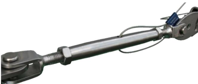
Tendeur chape-chape en inox 316. Permet de reprendre la tension du câble grâce à sa course de 23cm. **Un plomb avec un numéro de série est fourni. SecurLine recommande une tension de 250daN.**
