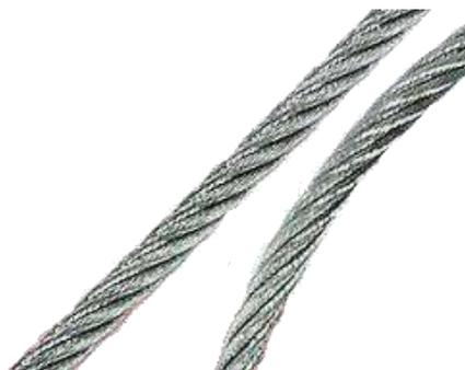
Câble en inox 316 de 8mm de diamètre composé de 7 torons de 19 fils. Le câble SecurLine possède un marquage dont la couleur change en fonction des lots.
