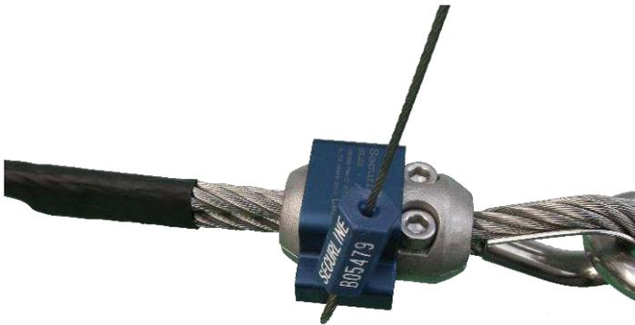
Système de terminaison manuelle à visser. Ce système permet la pose de la ligne de vie sans presse hydraulique. Ce système a une résistance supérieure à 3000daN. Une fois plombé, le système est indémontable.
