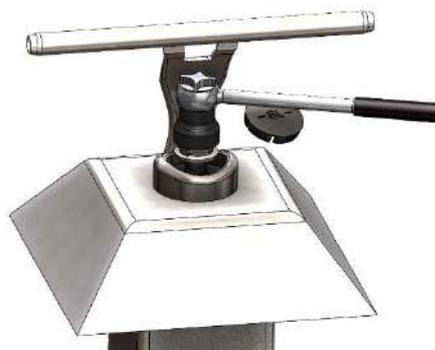
Les passants SL30 se mettent en place sur leur support par l'intermédiaire d'une vis M12 inox tête hexagonale. Le cache PVC doit être mis en place après le serrage au couple de 35N.m.
