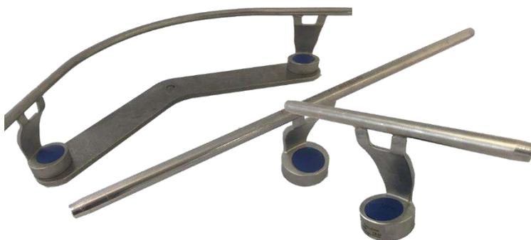
Passants automatiques en inox 304 passivés et électropolis, ces passants sont utilisables avec la navette SL50. Il existe 3 types de passants automatiques, le SL30 (intermédiaire sans angle), le SL31 pour les angles à 90° et les passants SL33 à angle réglable grâce à la platine à cintrer.
