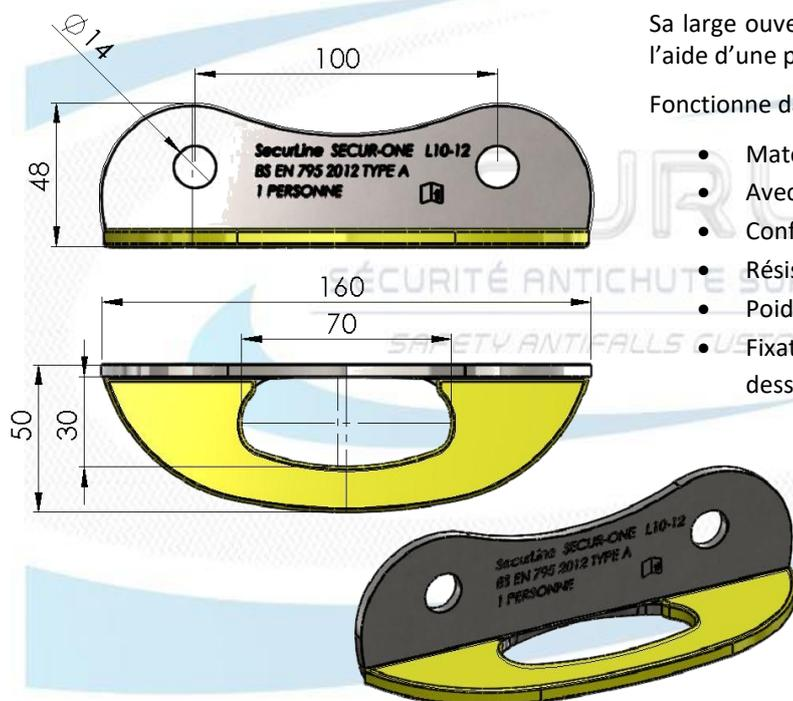
Plaquette d'ancrage individuel permettant de sécuriser un opérateur muni des EPI adaptés (lire le dossier technique).
