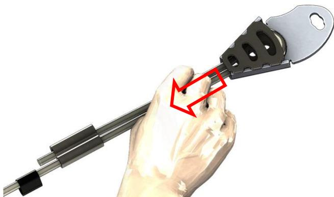
Rapprocher le double tube de la boîte à coin pour bloquer le câble. Mettre en place le plomb. Couper le câble et chauffer le thermdurcissable pour améliorer la finition :
