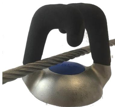
Passant intermédiaire permettant de franchir les potelets sans se déconnecter, avec l'aide d'un simple mousqueton. Ce passant ne peut être mis en place qu'en position murale ou au sol. Il ne peut donc pas être mis en position dite « plafond ».
