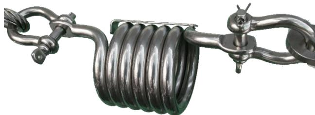
Absorbeur en inox 316 à dissipation d'énergie par déformation plastique avec 2 manilles lyres inox et goupilles fendues. **Le plateau de déformation plastique se situant entre 600daN et 750daN**, les efforts en extrémité se limitent donc le plus souvent à cette zone de valeur. La course de l'absorbeur est de 1 mètre, ce qui lui permet d'absorber beaucoup d'énergie.
