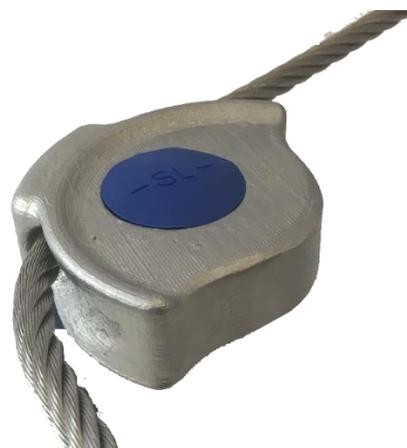
Passant d'angle pour potelets SECUR, SecurBac 2U ou sur mesure. Lors de la mise en place de la ligne de vie sur des potelets SecurBac 2U, l'angle ne doit pas excéder 60°.
