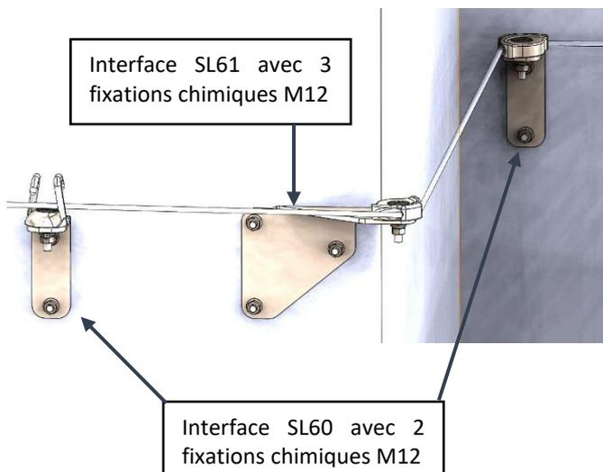
Les composants SL60 et SL61 ne sont pas pris en charge par les normes EN-795-C 2012 et TS 16 415 de 2013.
