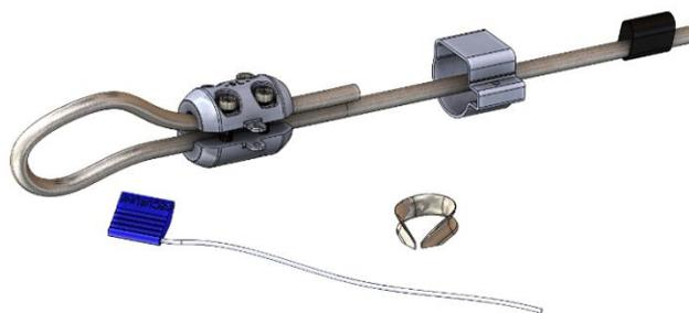
Une fois que la cosse cœur est prise dans le câble, serrer progressivement (en alternant) les 4 vis du manchon. À l'aide d'une clé dynamométrique, il faut contrôler que le couple de serrage est bien de 10Nm.
