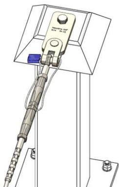
Le plomb est mis en place entre le trou situé au milieu du corps du tendeur et la chape du tendeur.
