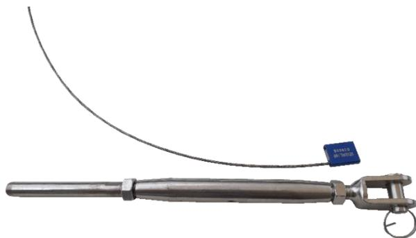
Tendeur en inox 316 avec une chape et un manchon à sertir diamètre 13mm. Un plomb avec un numéro de série est fourni. **SecurLine recommande une tension de 80daN.**
