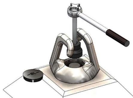
Serrer au couple de 35Nm. Un angle de 5° est toléré à l'entrée et à la sortie des passants intermédiaires SL05.
