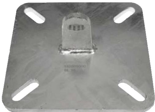
Platine d'extrémité en acier galvanisé. Peut être mise en position murale et toiture. Elle se fixe sur une structure métallique ou sur une maçonnerie. Cette platine permet de mieux répartir la charge par rapport à la platine SL11. On la privilégiera pour des maçonneries anciennes.
