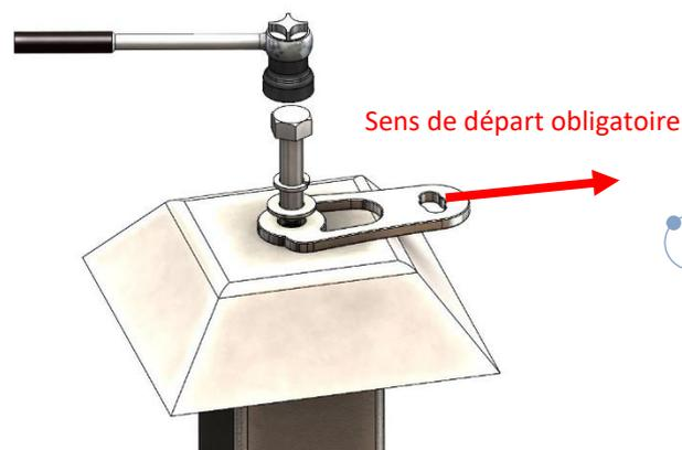
Les adaptateurs d'extrémité se montent en tête des potelets ou sur des interfaces sur mesure par l'intermédiaire d'une vis M12 inox. Il est également possible de mettre en place les SL14 directement sur une structure métallique. L'anti-desserrement est réalisé par une rondelle grower qui est placée entre la SL14 et la tête de la vis.
