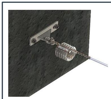
Les platines de départ SL11 doivent être mises en place par l'intermédiaire de 2 fixations M12 en inox. Si les fixations sont reprises dans un mur en béton, nous conseillons d'utiliser des scellements chimiques. Le couple de serrage des fixations devra être de 35Nm.
