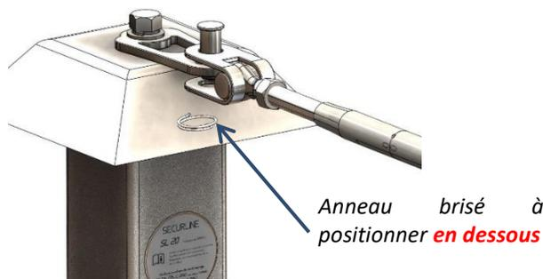
Comme le montre le schéma ci-dessus, l'anneau brisé doit toujours être positionné en dessous (sauf dans le cas où la chape est mise en place latéralement, sur un anneau par exemple)
